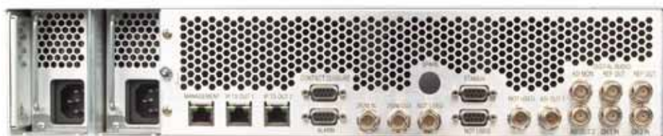
図 2. D9054 HDTV アドバンスド・コンプレッション・エンコーダ、リアパネル
